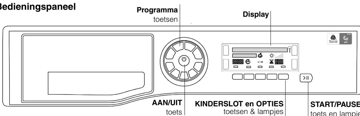
De toets **AAN/UIT** - als de droger in werking is en u op deze knop drukt: Als **STAND BY** wordt weergegeven op de display, dan stopt de droger. Als **INGEDRUKT HOUDEN** wordt weergegeven op de display, houdt dan de toets ingedrukt; de display zal aftellen van 3 naar 2 naar 1 en zal dan stoppen. Druk de toets opnieuw in en houdt hem meer dan 3 seconden ingedrukt, en dan zal er kort **INSCHAKELEN** worden weergegeven. .
