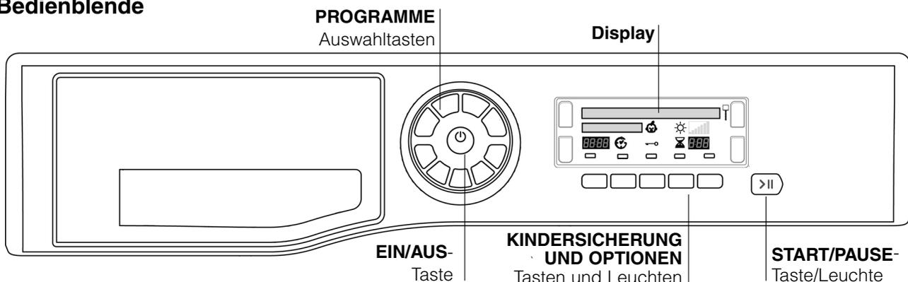
Die **EIN/AUS**-Taste - falls diese gedrückt wird, während der Trockner läuft: Falls das Display **AUSSCHALTEN** anzeigt, hält der Trockner an. Falls das Display **DRÜCKEN + HALTEN** anzeigt, halten Sie die Taste gedrückt. Das Display zählt nun 3, 2, 1 rückwärts und der Trockner hält dann an. Falls Sie die Taste erneut drücken und für mehr als 3 Sekunden gedrückt halten, zeigt das Display kurzzeitig **EINSCHALTEN** an.
