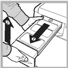
Tirez le réservoir pour l'extraire du sèche-linge et retirez le petit capot ou le grand capot, videz-le dans un évier ou autre, pour en éliminer le contenu. Remettez en place le capot et remettez le réservoir bien en place.
