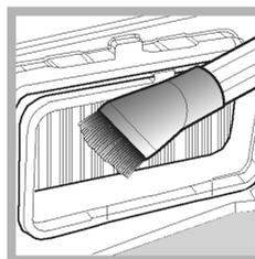
4. Retirez soigneusement ces peluches à l'aide d'un linge humide, d'une éponge ou d'un aspirateur. Ne JAMAIS utiliser vos doigts.
