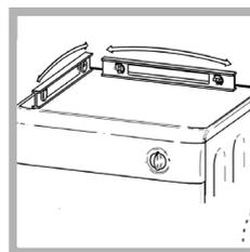
Wenn Sie den Trockner an seinen endgültigen Platz gestellt haben, kontrollieren Sie, ob er waagrecht steht, seitlich und von vorn nach hinten. Sollte der Trockner nicht waagrecht stehen, justieren Sie die vorderen Füße nach oben oder unten, bis der Trockner waagrecht steht.
