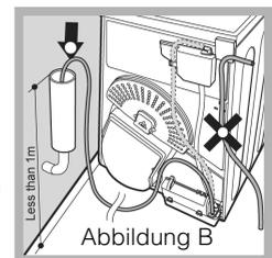
! Sicherstellen, dass der Schlauch nicht zusammengedrückt wird oder Knickstellen bekommt, wenn sich der Wäschetrockner an seinem vorgesehenen Standort befindet.
