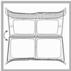
2. Öffnen Sie den Filter und entfernen Sie die Flusen von der Innenseite.
