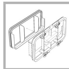
! L'avant de la pompe à chaleur est fait de fines plaques métalliques. Veillez à ne pas les endommager et à ne pas vous couper lors du nettoyage, en retirant et en remplaçant le filtre.
