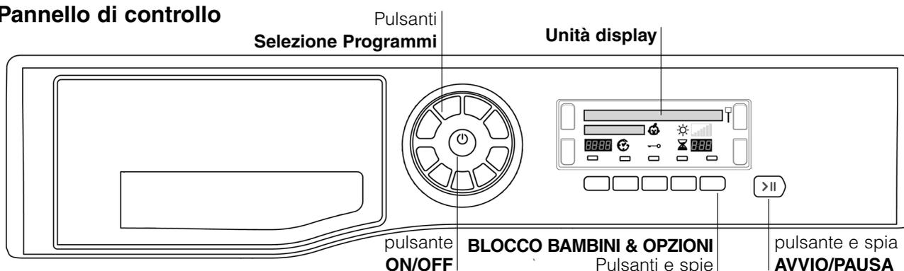
Il pulsante ON/OFF - se premuto quando l'asciugabiancheria è in esecuzione il display visualizza **SPEGNIMENTO IN CORSO** | l'asciugabiancheria si arresta. Se il display visualizza **TIENI PREMUTO PER SPEGNERE** tenere premuto il bottone e il conteggio del display esegue un conto alla rovescia 3, 2, 1 e poi si ferma. Premere e tenere premuto per più di 3 secondi, sul display appare brevemente **ACCENSIONE IN CORSO**
