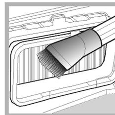
4. Entfernen Sie die Flusen vorsichtig mit einem feuchten Tuch oder Schwamm oder mit einem Staubsauger. NIEMALS mit den Fingern.
