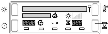
Nadat u een programma hebt geselecteerd met de optie Drogen voor een bepaalde tijd, drukt u op de Tijdsknop
