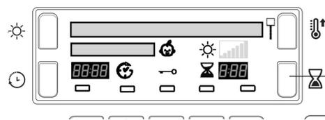
Nach der Auswahl eines Programms, das die Option Zeitgesteuertes Trocknen hat, drücken Sie die Zeitdauer-Taste
