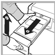
Ziehen Sie den Behälter aus dem Trockner und entfernen Sie entweder die kleine oder große Kappe und entleeren Sie ihn in ein Waschbecken oder einen anderen geeigneten Abfluss.
