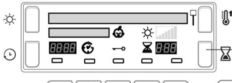
Après avoir sélectionné un programme comportant une option Séchage minuté, appuyez sur le bouton de durée de séchage ⏰ : le temps sélectionné augmente sur l'affichage chaque fois que vous appuyez brièvement sur le bouton (voir *Démarrage et Programmes*).
