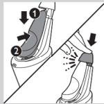
**3** Posizionate il rasoio nel supporto, inclinate il rasoio all'indietro e premete verso il basso il coperchio superiore per collegare il rasoio fino a farlo scattare in posizione.
