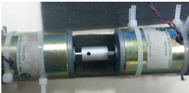
Figura 1.0.3: Blocco motore: Gebr Bühler Nachf. Motor
