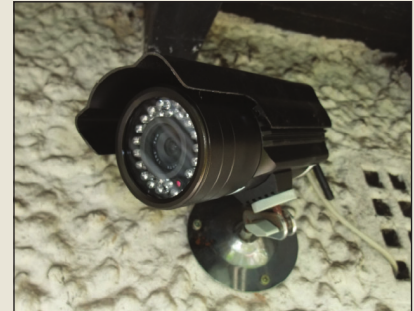
Una videocamera IP esterna. I LED intorno alle lenti sono infrarossi per l'illuminazione notturna
